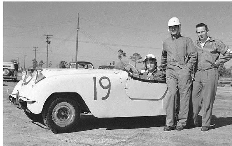
La Crosley HotShot, débarrassée de son pare-brise à la place duquel on a installé un petit saute-vent fabriqué avec un morceau de plexiglas trouvé sur place dans les surplus aéronautiques. Vic Sharpe est à droite avec le brassard de mécanicien.
